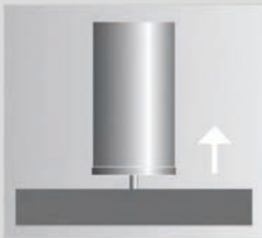
Der Bolzen berührt das Werkstück, wird abgehoben, und der Lichtbogen wird eingeleitet.
