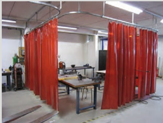
Folienvorhänge in RT (Rot, transparent) an C-Profil mit Hakengleiter befestigt.
