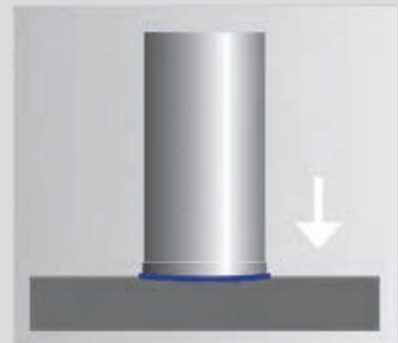
Der Bolzen taucht in die sehr flache Einbrandzone ein und wird unlösbar verbunden.
