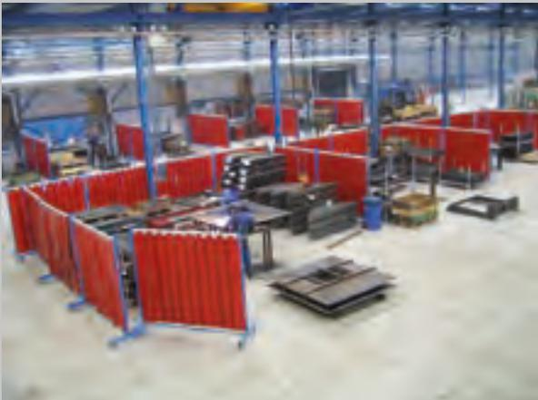
Einteilige Schutzwände mit Lamellenvorhang in RT (Rot, transparent) sind mit Pendelschalen am Rohr befestigt. Die Schutzwände sind dank des Rädersatzes mobil.
