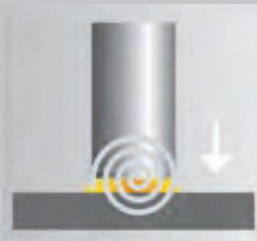
Der Lichtbogen wird spiralförmig durch das Magnetfeld geführt und schmilzt beide Fügeteile vollflächig an.
