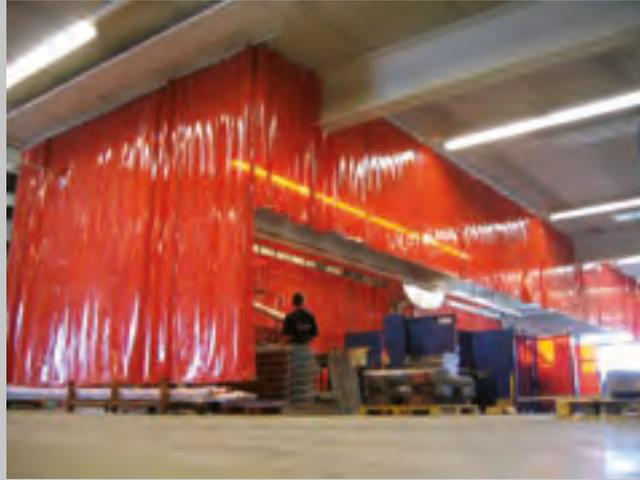
Folienvorhänge in RT (Rot, transparent) an Rohr mit Metallhaken befestigt.
