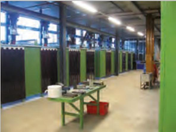
Lamellenvorhänge in BT (Bronze, transparent) sind am Rohr mit Pendelschalen befestigt. Die Lamellenvorhänge sind zwischen den Wandelementen zur räumlichen Trennung eingebaut.
