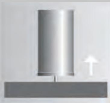
Der Bolzen berührt das Werkstück, wird abgehoben, und der Lichtbogen wird eingeleitet.
